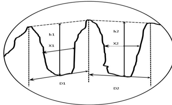
Fig.5. Pore microroughness parameters
